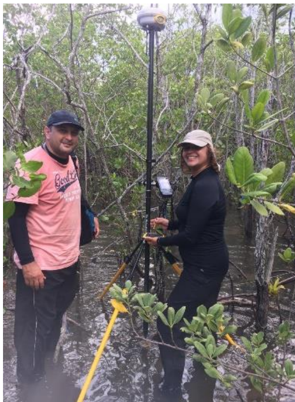
Figura 9: Medição dos marcos geodésicos com RTK no interior das parcelas durante o PMBA.
